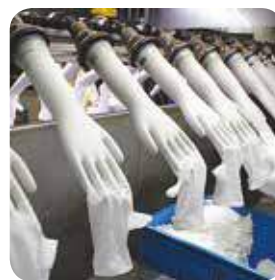
► Démoulage des gants
