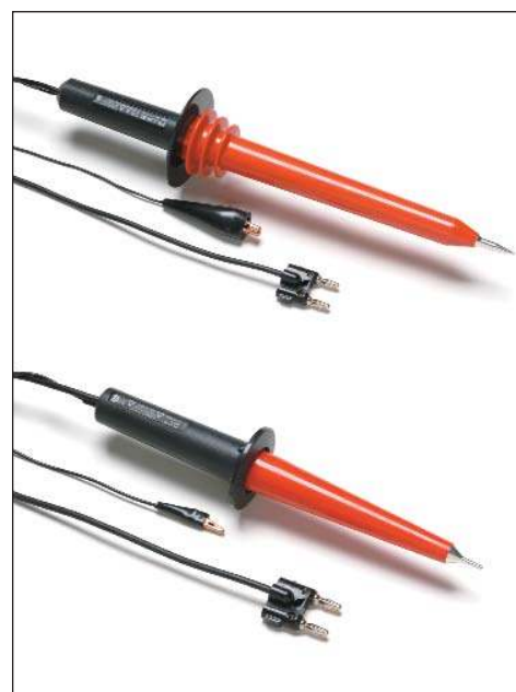
Afbeelding 3. Accessoires zoals de hoogspanningsmeetprobes Fluke 80K-40 en 80K-6 vergroten het spanningsmeetbereik van een DMM.
