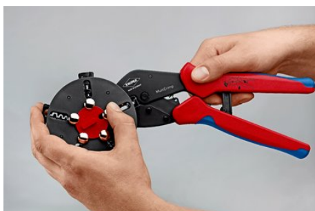
Changement de la matrice de sertissage : déverrouiller la position du magasin, extraire la matrice de la pince
