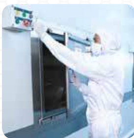
► Handschoen wassen in gedeïoniseerd water van hoge kwaliteit
